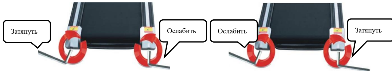
Рисунок А: Беговое полотно смещается влево Рисунок В: Беговое полотно смещается вправо
